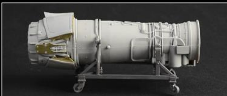
Motore RB.199 estraibile con carrello speciale di supporto
